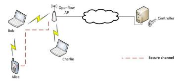
Fig. 1. Application scenario using SDN.
